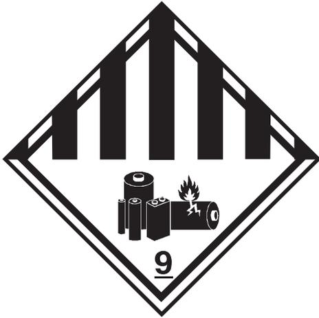
**Indications sur le module de batteries :**
